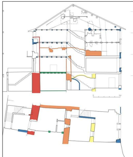
Fig. 19 : Coupe transversale et plan des bâtiments situés à la rue de l'Hôpital 1, 3 et 5.
