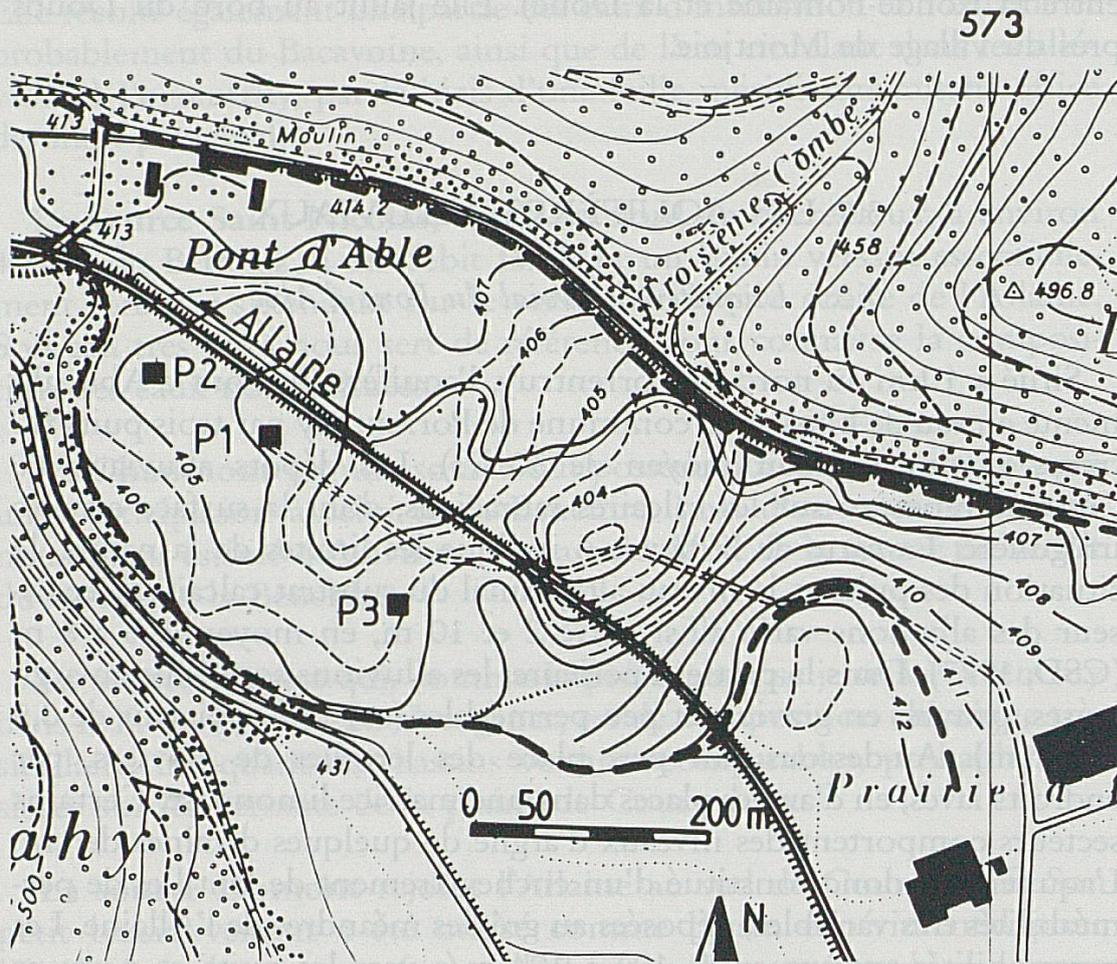
On peut distinguer les secteurs des puits nord et centre, alimentés par l'Allaine et par l'aquifère du Betteraz, et le secteur du puits sud, jamais clairement touché par un essai de traçage et dont la composition chimique des eaux (en particulier le sodium, le potassium et le sulfate) indique des apports différents, probablement du versant sud-ouest. Les réserves contenues dans l'aquifère peuvent être évaluées à un peu plus de 70 000 m<sup>3</sup>.
