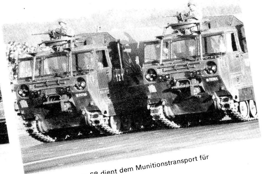
Der Raupenpanzer 68 dient dem Munitionstransport für die Panzerartillerie.
