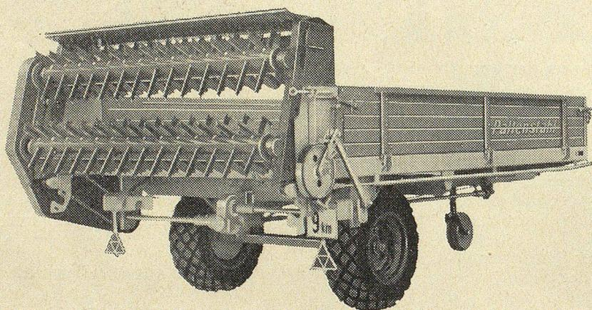
Konstruktiv der Zeit voraus, dank jahrzehntelanger Erfahrung im Bau von Stallmiststreuern! Fein wie ein Schleier und gleichmäßig wie ein Teppich, das ist die sprichwörtliche Streuarbeit des «Paltenstahl». — Sprichwörtlich ist aber auch seine robuste, unkomplizierte Bauweise. Alle Bestandteile sind leicht zugänglich — vor- und rückwärtslaufender Kratzboden, leichtzügig, Ölbadgetriebe. Einziger Miststreuer, welcher ins Steyr-Agrar-System aufgenommen wurde.
