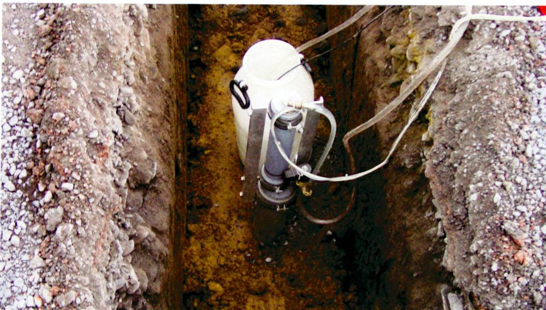
Bestimmung der Wasserdurchlässigkeit nach dem Open-End-Verfahren.
