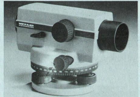
Beide Instrumente sind sogenannte «Automaten», bei denen die Ziellinie durch einen Kompensator automatisch horizontal wird.
