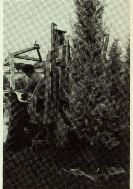
versehen, die verhindert, dass sich der Traktor in dem Moment abhebt, wenn die Spaten in die Erde stechen. Das Gerät kann auch zum Löchergraben beim Umpflanzen benutzt werden. (Mitteilung der Vertriebsfirma Silent AG, Dällikon/ZH)
