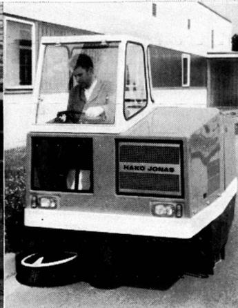
Hako-Jonas 1400 hydraulische Kehrsaugmaschine für Industrie- und Kommunalbetriebe, 10.000 m<sup>2</sup>/h
