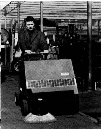
Hako-Hamster Kehrsaugmaschine mit Benzinmotor. Vor-Rückwärts kehren und reinigen mit Staubsauger mit Scheibenbremse und Sitzkarren bis 4600 m<sup>2</sup>/h.
