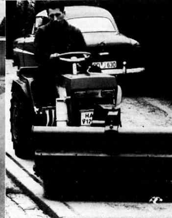
Hako-Trac mit hydraulisch auszuhebender Frontkehrmaschine 120 cm breit, 8000 m<sup>2</sup>/h, sehr gut geeignet für alle Arbeiten rund um die Fabrik.
