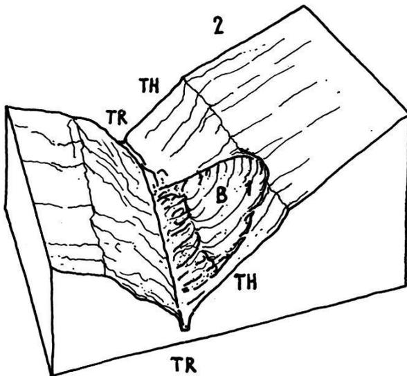
**Fig. 113** Ausgleichscatena bei unter-schnittenem Gehänge in einem Tobel. Nur ein Ober- und Mittelgehänge (1 und 2) sind ausgebildet; die Alluvialzone fehlt.
