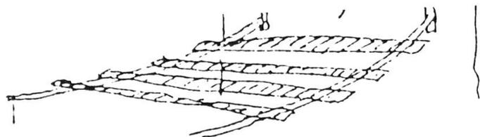
Um Gefahr zu vermeiden, legte man noch über den beiden Ketten Bretter der Länge nach, die in der Figur rechts weggelassen sind. Auf dieser Brücke nun ward ganz gemächlich links & rechts die oberen Ketten zusammengesetzt, die ganz gleich der unteren ist, an der aber je ein Gelenk über die Mitte eines unteren Gliedes zu liegen kommt. Die obere steht von der unteren etwa um 1 Fuß ab. Als endlich diese Arbeit fertig war, wurden die Thürme oben zugemauert; von der obe-
