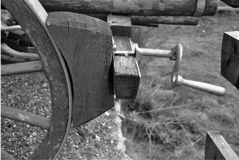
Dans la pente, pour freiner le char, il fallait serrer la « mécanique ». Photo Bretz, 2013.
