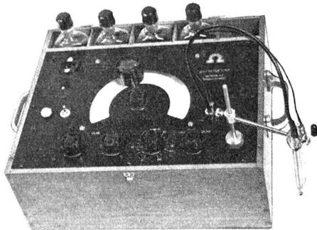
Messbereich: 0-14 pH, 0-1000 mV. Genauigkeit: 0,2 pH, 2 mV.
