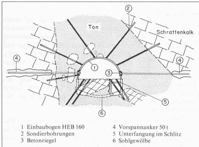
Bild 4. Deutsche Bauweise, genereller Arbeitsablauf
