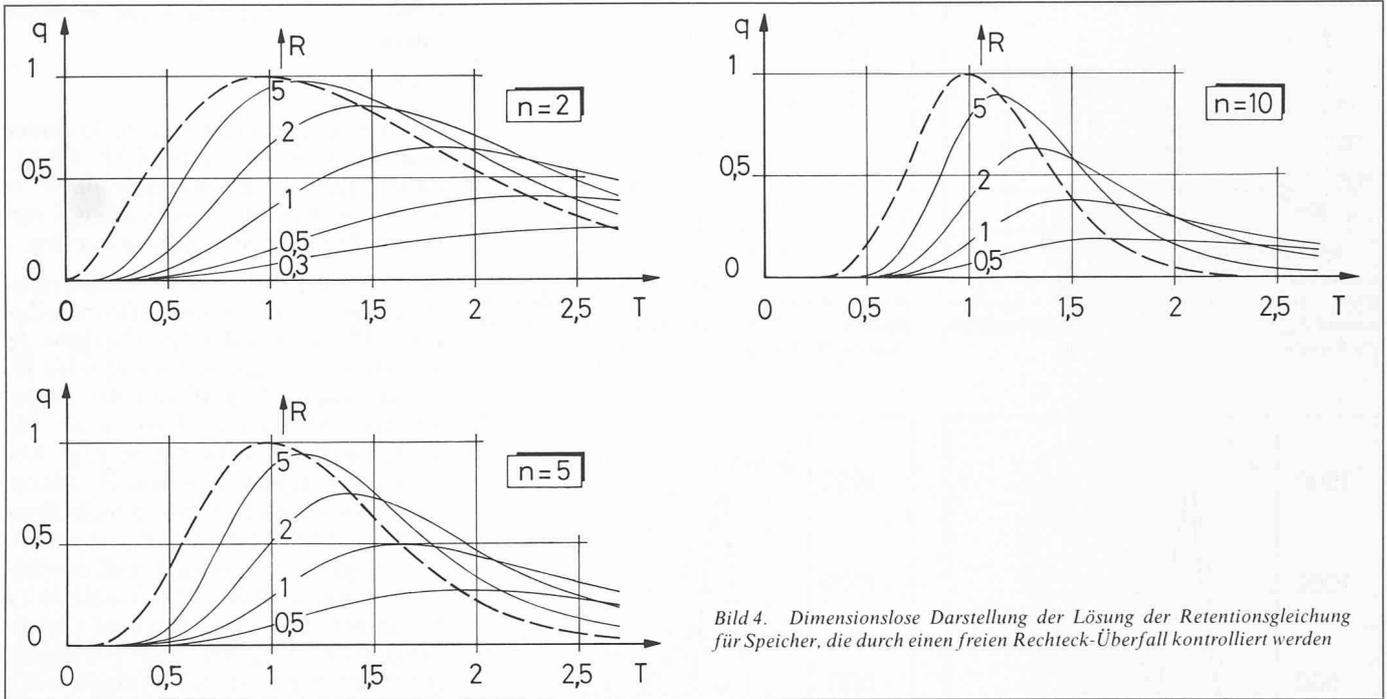
Bild 4. Dimensionslose Darstellung der Lösung der Retentionsgleichung für Speicher, die durch einen freien Rechteck-Überfall kontrolliert werden
