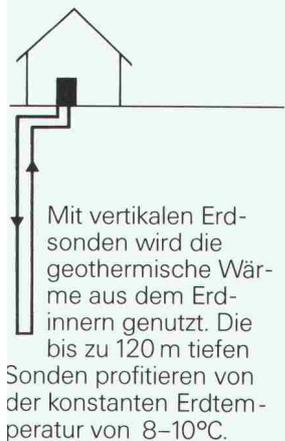
Mit vertikalen Erdsonden wird die geothermische Wärme aus dem Erdinnern genutzt. Die bis zu 120 m tiefen Sonden profitieren von der konstanten Erdtemperatur von 8-10°C.
