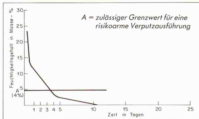
Austrocknung von Holzspanbetonsteinen
