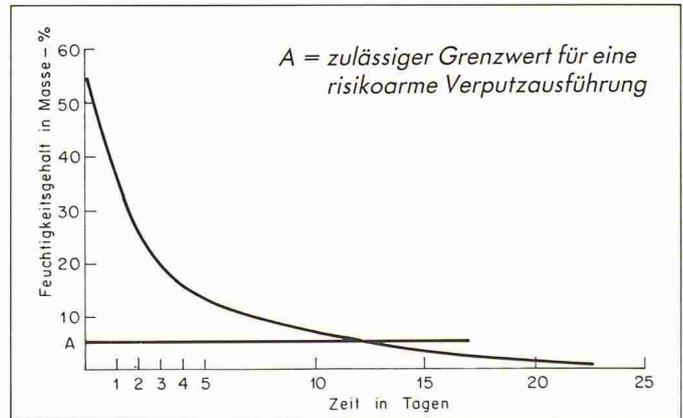
Austrocknung von Gasbetonsteinen, Grösse 10x25x62 cm
