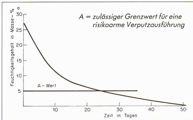
Austrocknung von Gasbetonsteinen, Grösse 25x25x62 cm
