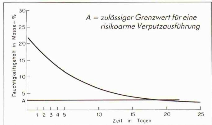
Austrocknung von Backstein nach Feuchtigkeitssättigung; die Austrocknung erfolgte über zwei Flächen, die übrigen Seiten waren mit einer Plastikfolie geschützt
