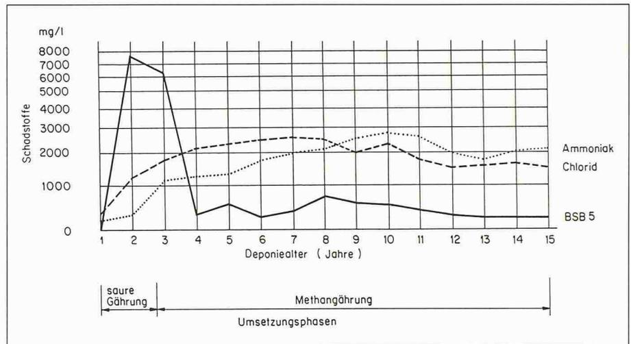
Bild 1. Sickerwasserbelastung
