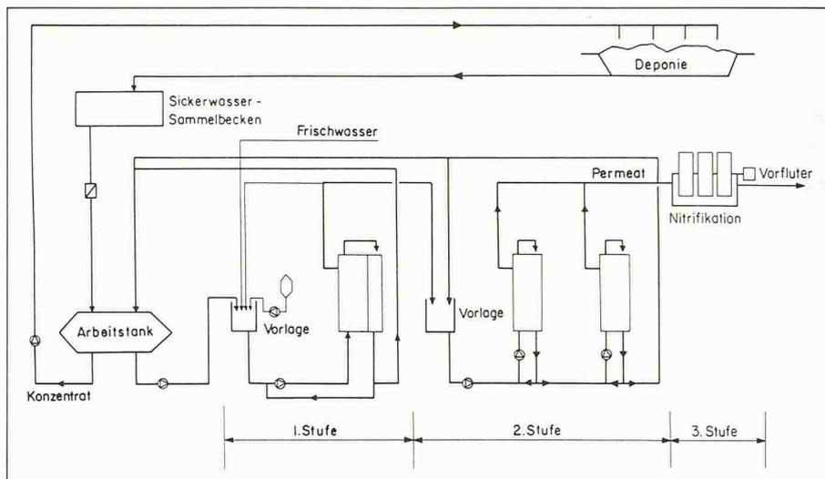
Bild 6. Schema Umkehrosmose-Anlage mit Nitrifikation
