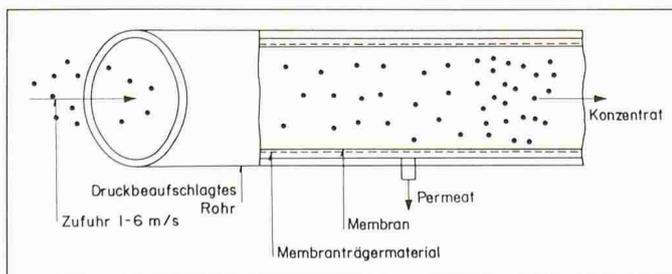
Bild 2. Rohrmembrane
