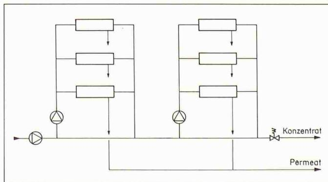
Bild 5. Rezirkulationsschaltung
