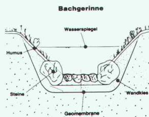
MONARFLEX Geomembranen liefern wir in Rollen von 4 x 25 m ab Lager oder fertig vorkonfektioniert.
