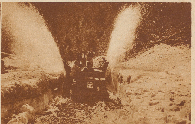
Auf der Klausenstraße wurde dieser Tage ein neuer Schneepflug der Firma F. Marti A.-G. in Bern ausprobiert. An den Traktor von 5,4 Tonnen Gewicht war vorn ein 1,8 Tonnen schwerer Schneepflug angekuppelt. Der von Pflug beidseitig weggeschobene Schnee wird von zwei Propellern fortgeschleudert (Prephot. Basel)
