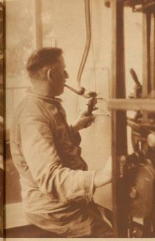
Der Handhändler am Pantograph. Er sitzt an einem Ende der Maschine, um dem Pantograph oder Stützschubstiel über die Zeichnung zu führen. Dieser Hebel, mit der Spitze die Schablone betreuend, überträgt die Größe des Musters scharf verkleinert auf die Stickfläche
