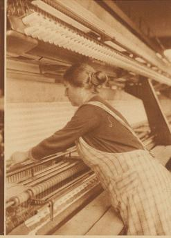
Während der Klemmen ein Handhändler am Pantograph sitzt, überwaht und bedient seine Frau die Maschine. Diese arbeitet zweiseitig, mit zwei übereinanderliegenden Wagen, die je ein Stück Stoff bereiten
