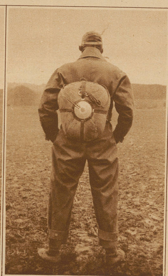
Der zusammengefaltete Fallschirm auf dem Rücken des Fliegers. Der Karabinerhaken an der Reißleine wird am Flugzeug befestigt. Springs der Flieger ab, so wird auch auf diese Weise der Schirm zum Öffnen gebracht
