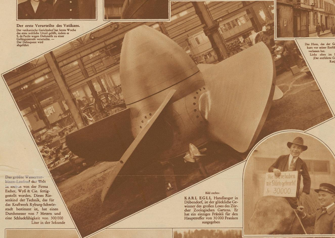
Das größte Wasserturbinen-Laufrad der Welt ist soeben von der Firma Escher, Wyß & Cie. fertiggestellt worden. Dieses Riesenkind der Technik, das für das Kraftwerk Ryburg-Schwörstadt bestimmt ist, hat einen Durchmesser von 7 Metern und eine Schluckfähigkeit von 300 000 Liter in der Sekunde
