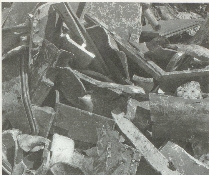
Auf dieses Kleinformat hat die Schere die Wanne zerkleinert.
