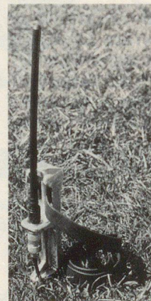
Antenne SEA 80 K betriebsbereit auf einer Wiese und an einem Gartengag montiert
