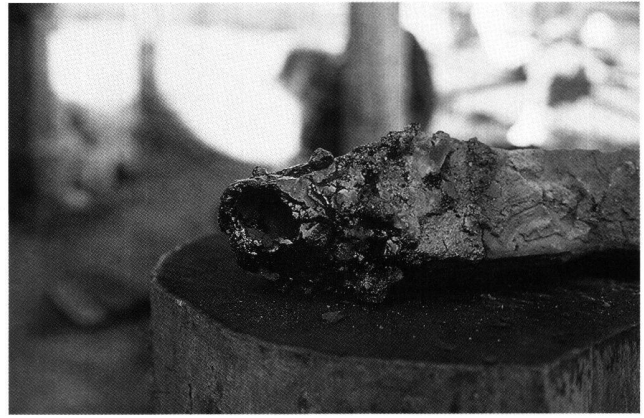
Fig. 6 Tuyère expérimentale, Boécourt, Les Lavoirs.
