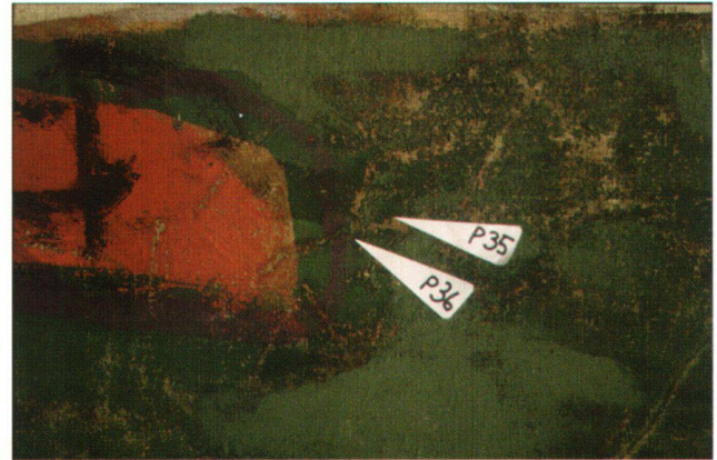
Abb. 2 Karton I: Linker Fuss der Mittelfigur. Die rote Fussspitze ist von der Hintergrundfläche in dunklerem Grün eingefasst. Spätere Überarbeitungen mit hellerem Grün und violetter Umrisslinie. Entnahmestelle der Proben Nrn. 35 und 36. Schadensbild: Abgewetzte Farbe vor allem im dunkleren (älteren) Grün (Bildmitte). Detailaufnahme, Länge der Pfeile = 24 mm.
