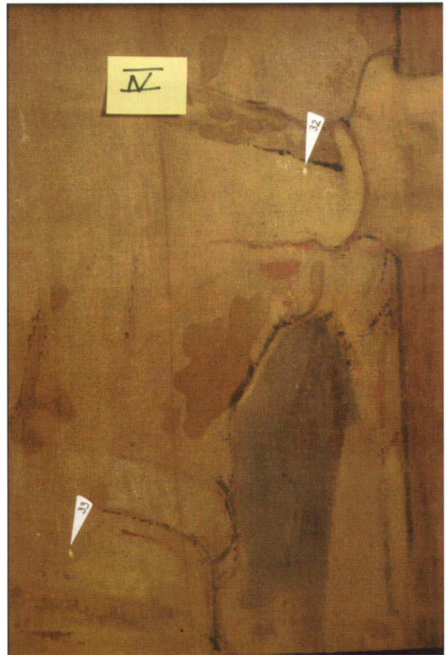
Abb. 18 Karton IV, Ausschnitt der Rückseite im rechten unteren Bildteil (Gewebeteil [GT4], Bereich des Hellebardiers): Durchgedrungene Farben, Linien und Flächen. Die gelbe Farbe (Proben Nrn. 32, 33, Pfeile) enthält Strontiumgelb, Bleiweiss und Baryt. In der Bildmitte Bindemittelfleck einer frühen Festigung.
