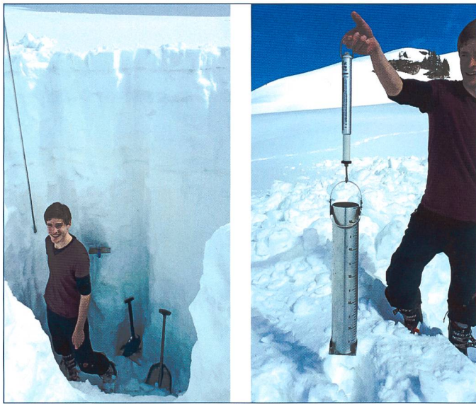
Bild 2, oben. Schneedichtemessung mit der sog. ETH-Sonde.
