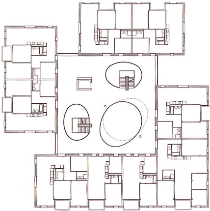
Gebäudegruppe Nord, Normalgrundriss mit grösseren Einheiten
