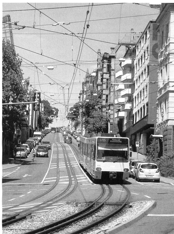
Stadtbahn Stuttgart in beengten Strassenverhältnissen. Trotz grundsätzlichem Eigentrassee die kann die Stadtbahn abschnittsweise auch im Mischverkehr geführt und damit flexibel in den Stadtraum integriert werden.
