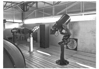
Die beiden Hauptteleskope verfügen über unabhängige Fundamente
