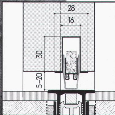
Schwellose Türverschlüsse von Planet trennen laut und leise (Modell WS, hier in idealer Kombination mit Boden-Trennschiene BT), schützen vor Wärmeverlust und Zugluft, vor Rauch und Nässe und machen Räume rollstuhlgängig. Schwellose Türverschlüsse von Planet können einfach in jede Tür eingebaut werden. Auch nachträglich. Anruf genügt. Wir rufen zurück.
