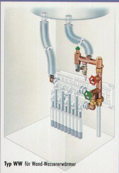
Typ WW für Wand-Wassererwärmer
