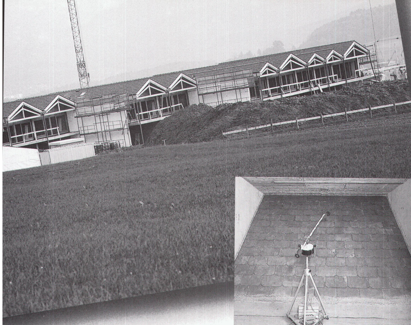
Luftschallprüfung am Grossmodell EMPA Zürich
