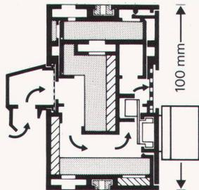
**Fenster-Zuluftelemente Typ ZE 100** sorgen für Frischluft und schützen vor Lärm. Sie fügen sich in jeden Blendrahmen und Glasfalz und sind darum – bei Sanierungen etwa – die ideale Lösung.
