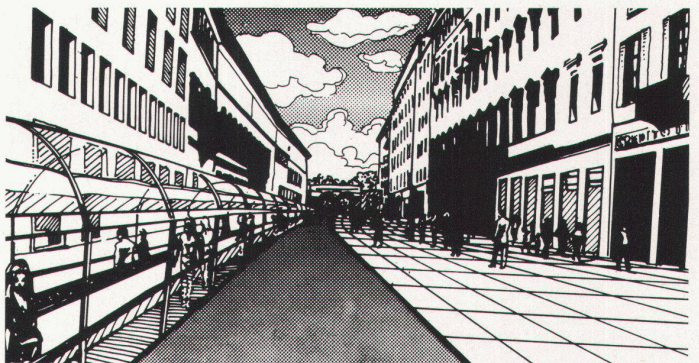
und für den Verkehr mit öffentlichen Transportmitteln (Krankswagen, Taxi, Autobussen, Feuerwehrwagen u. a.), elektrisch angetriebenen Gütertransportwagen und Vehikeln für Invalide reserviert. Der rechte Strassenrand ist breiter als die anderen zwei Bereiche, ist autofrei, mit Platten belegt und erlaubt den Fussgängern eine bessere Bewegungsfreiheit.
