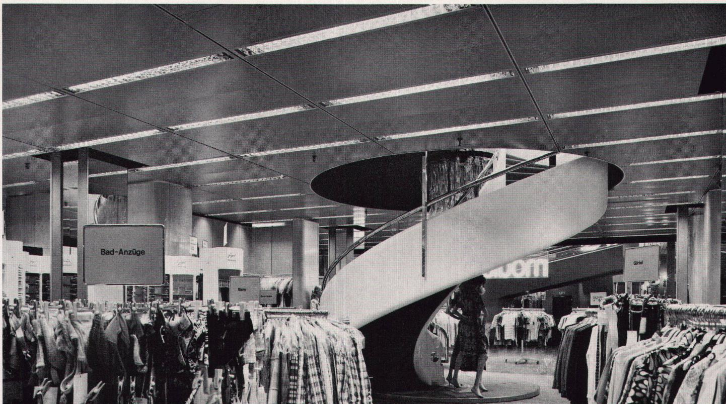
**Hier** –in einem Ladenraum der Firma Modissa im Einkaufszentrum Spreitenbach – wurde eine mit Stromschienen ausgestattete Gema-Metaldecke installiert.
