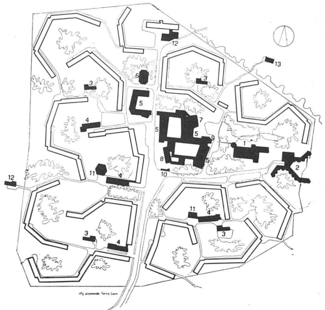
Wohnquartier Falchera, Turin. Architekt G. Astengo und Mitarb. Lageplan 1:8000. 6000 Bewohner, 30,3 ha, dreigeschossige Bauten mit ausgesprochener Raumbildung | Quartier d'habitation à Turin | Residential quarter in Turin
