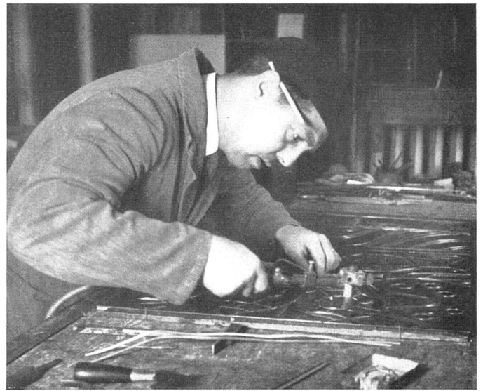
11 Verlöten der Bundstellen | Le verrier soude les jointures | The glass-maker solders the joints
