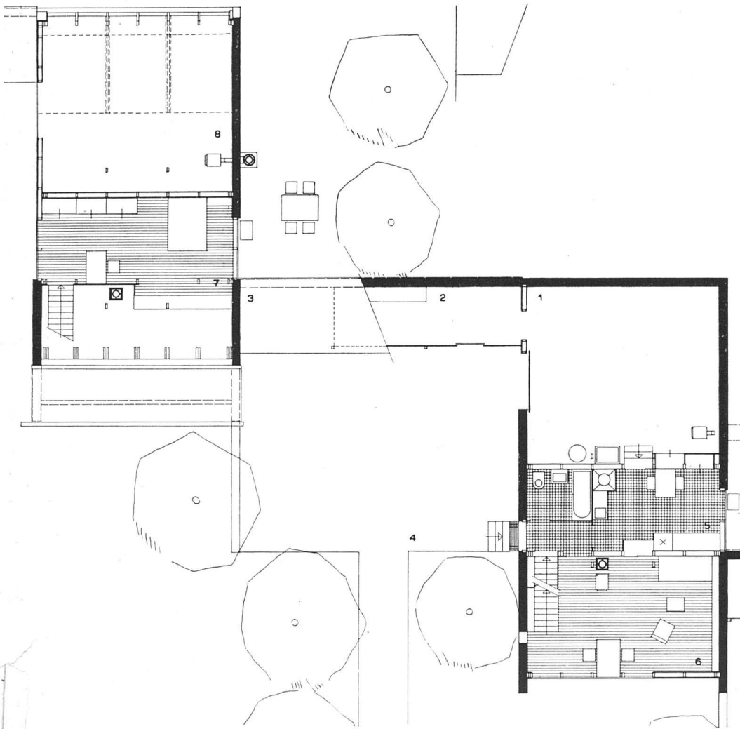
Typ C, großes Bildhauer- atelier mit Wohnung 1:200, links Obergeschoß, rechts Erd- geschoß | Type C, grand ate- lier de sculpteur avec ap- partement; à gauche l'étage, à droite le rez-de-chaussée | Type C, large sculptor's stu- dio with flat; upper story at left, ground floor at right
