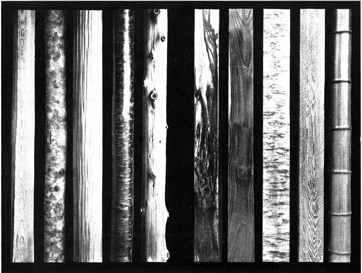
Verschiedene Arten Pfosten vor der Bildernische (Tokonoma) im Wohnzimmer von links: Sugispaltholz, Rundstamm aus Kobushi, poliertes entrindetes Sugirundholz, Kirschbaumrundholz mit Rinde, Hinokistamm mit Astknoten; vierkantige Pfosten aus Kurokakiholz, Ahornholz, Sugiholz, Bambus
