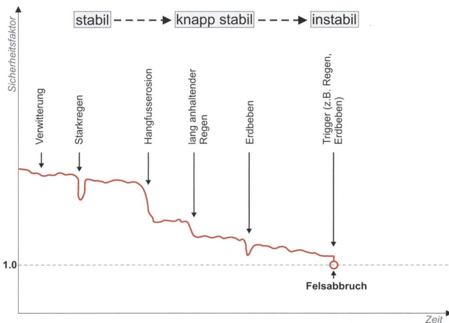
Fig. 2: Veränderung des Sicherheitsfaktors vs. Zeit in einem fiktiven Beispiel einer grossen Felsinstabilität (nach Popescu 2002).
