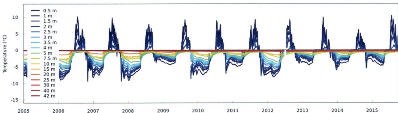
Fig. 1: Temperaturentwicklung im Permafrost. Erwärmung im Bohrloch Murtel-Corvatsch (Engadin) seit 2005 (Tiefen bis 42 m; Quelle: [www.permos.ch](http://www.permos.ch)).
