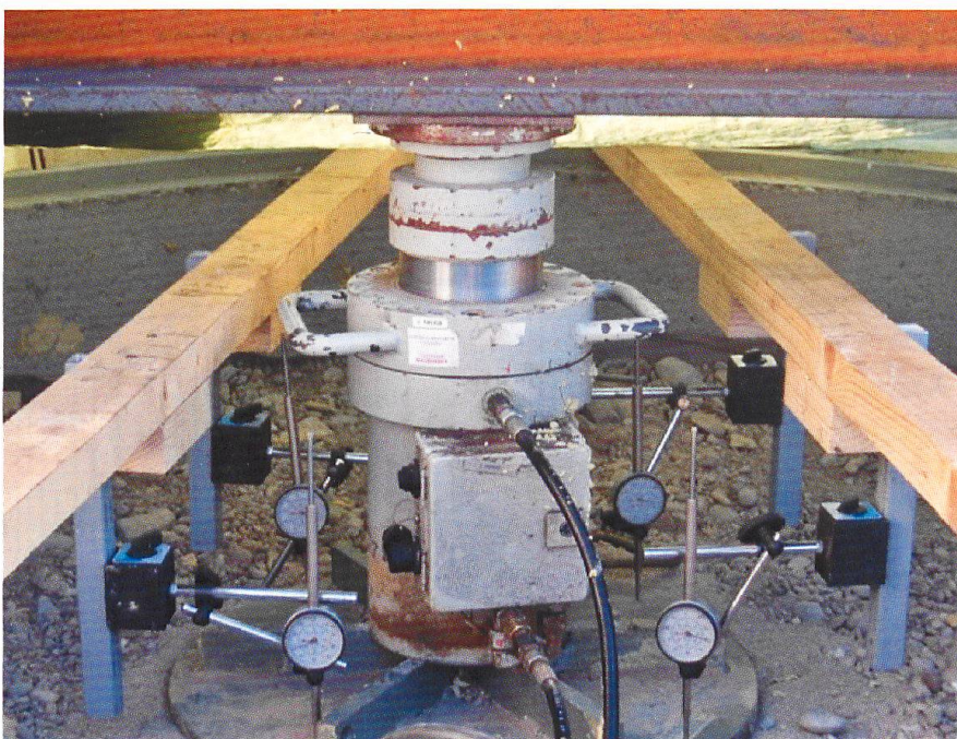
Fig. 4: Hydraulikzylinder und Lastplatte mit angesetzten Messuhren.
