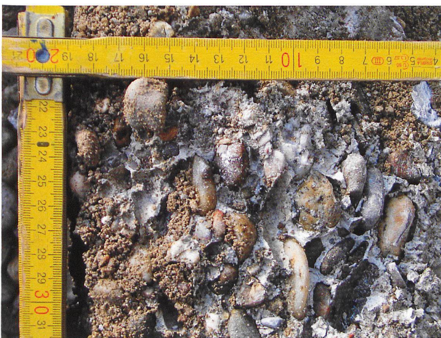
Fig. 9: Nahaufnahme der Injektion.
