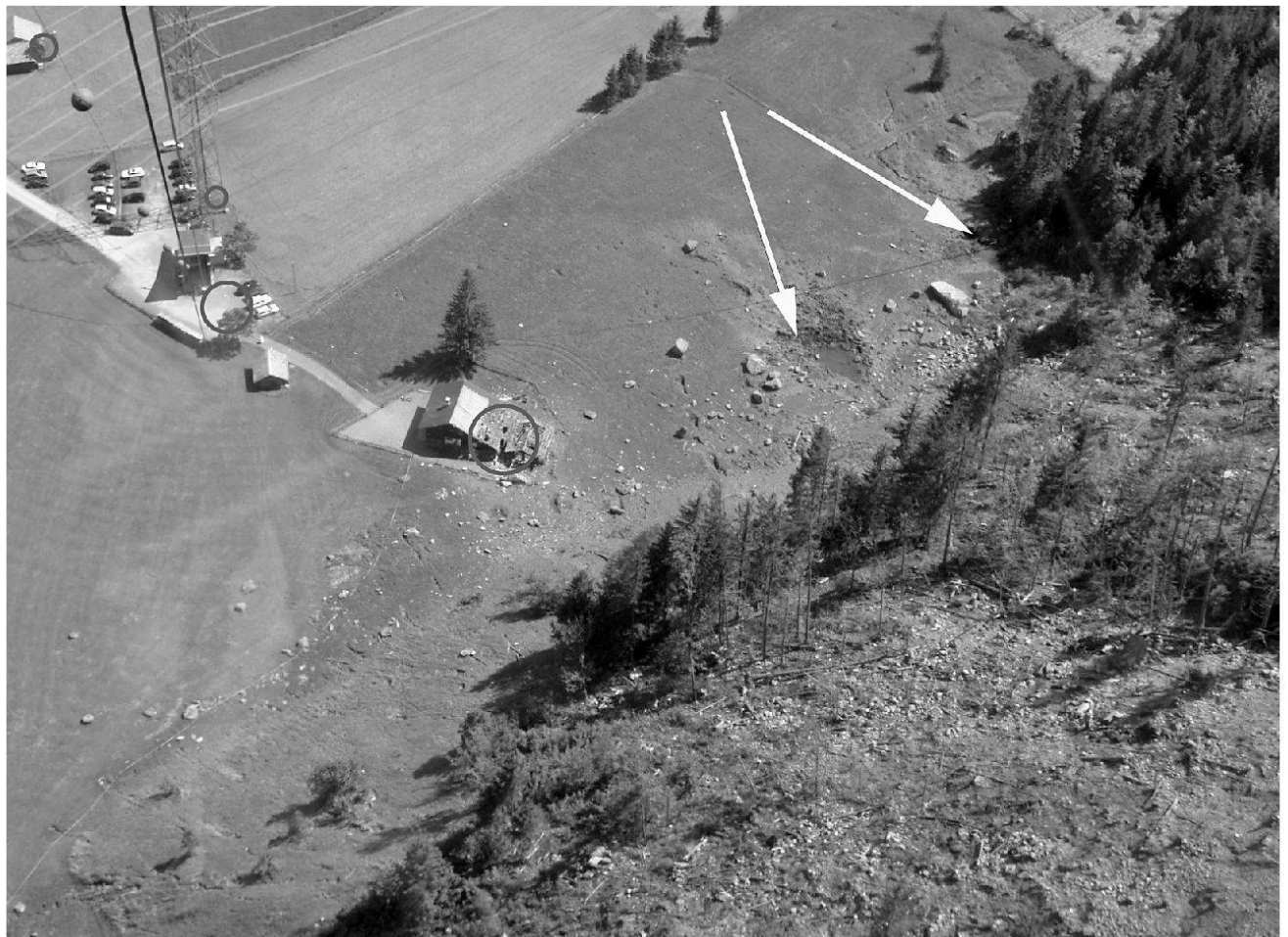
Fig. 2: Aufnahme des Sturzgebietes aus der Seilbahnkabine mit Streufeld der Blöcke, Einschlagtrichter von zwei Grossblöcken (Pfeile), beschädigtem Haus und Talstation der Allmenalpabahn. Kreise = Schäden durch Treffer von Steinen und kleinen Blöcken.
