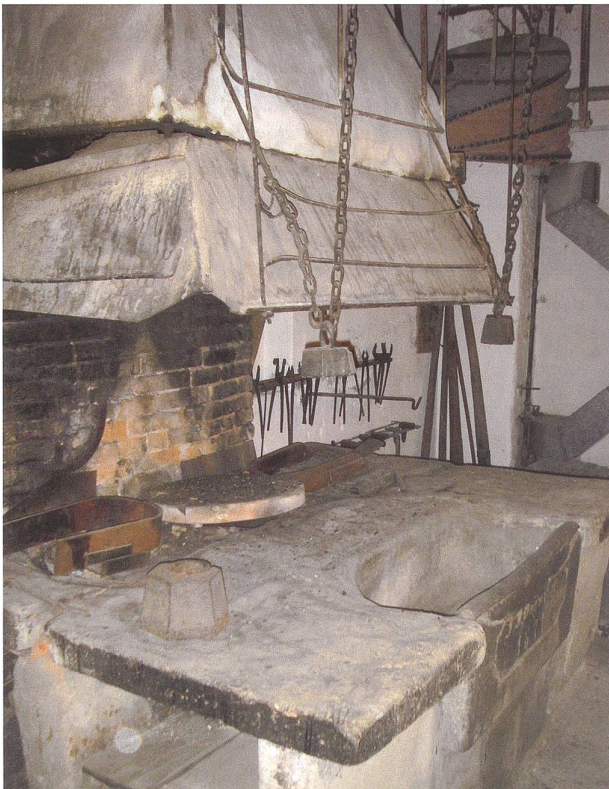
Abb. 25 Cham, Zugerstrasse 5, Schmiede. Der Schmiedetisch mit zwei Essen und einem Brunnentrog aus der zweiten Hälfte des 19. Jahrhunderts.
