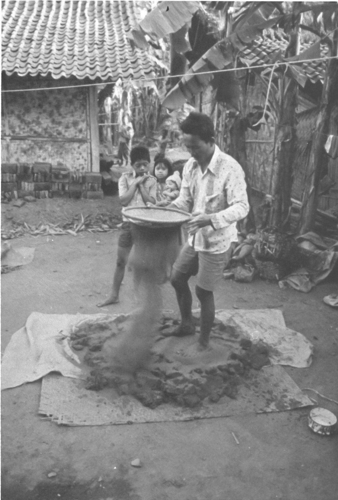
Abb. 1 Zubereiten des Tonkuchens mit Sand als Magerungsmittel
