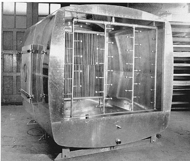
Luftwäscher und Befeuchter aus Aluminium geschweißt
