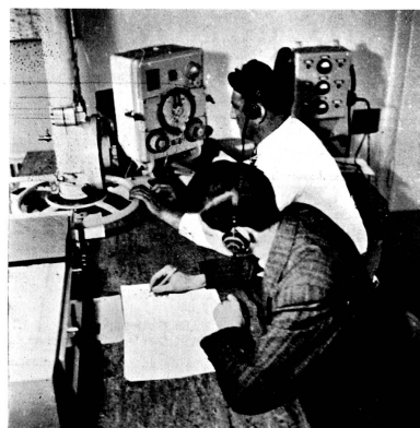
Der Funker am Nahzonenpeiler. Im Hintergrund rechts das Bakenkontrollgerät zur Betätigung der Blindlandanlage.
