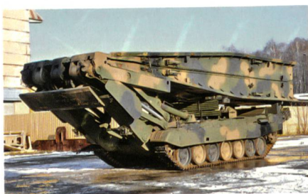
Brückenlegepanzer MG-20 Daglezja-G.
