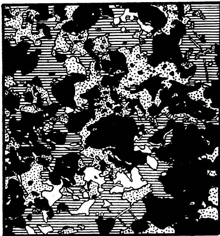
Fig. 2. Zeichnung nach Anschliffphotographie. Alpin umkristallisiertes Pb-Zn-Cu-Erz am Bristenstock (Vorkommen Knappere). Sehr innige, feinkörnige Verwachsung von Bleiglantz (weiss), Kupferkies (horizontal schraffiert), Zinkblende (punktiert) und Gangart (schwarz). Ausschnitt aus Fig. 14 in JENNI, 1973.
