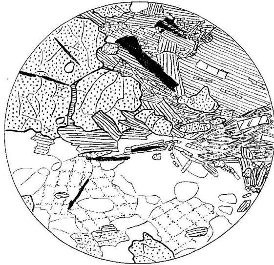
Fig. 2. Camp. Q 296. Termine di passaggio tra gneiss biotitico-sillimanitico e granulite acida. Alpe Vazzo. Biotite (con sfaldature), granato (a punteggiatura pesante), sillimanite (in aghetti, con qualche cristallo grande), quarzo, plagioclasio (punteggiature limitate), ortoclasio (con sfaldature punteggiate), grafite (nera). Disegno originale. 30 ×.
