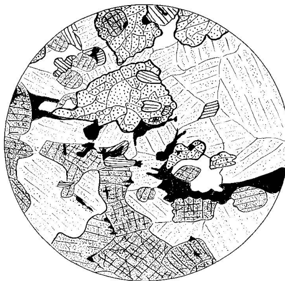
Fig. 7. Camp. Q 279. Granulite basica. Piana di Forno. Granato (a punteggiatura pesante), pirosseno rombico (a punteggiatura leggera), biotite (con sfaldature), plagioclasio (punteggiato a strisce), quarzo, ilmenite (nera).
